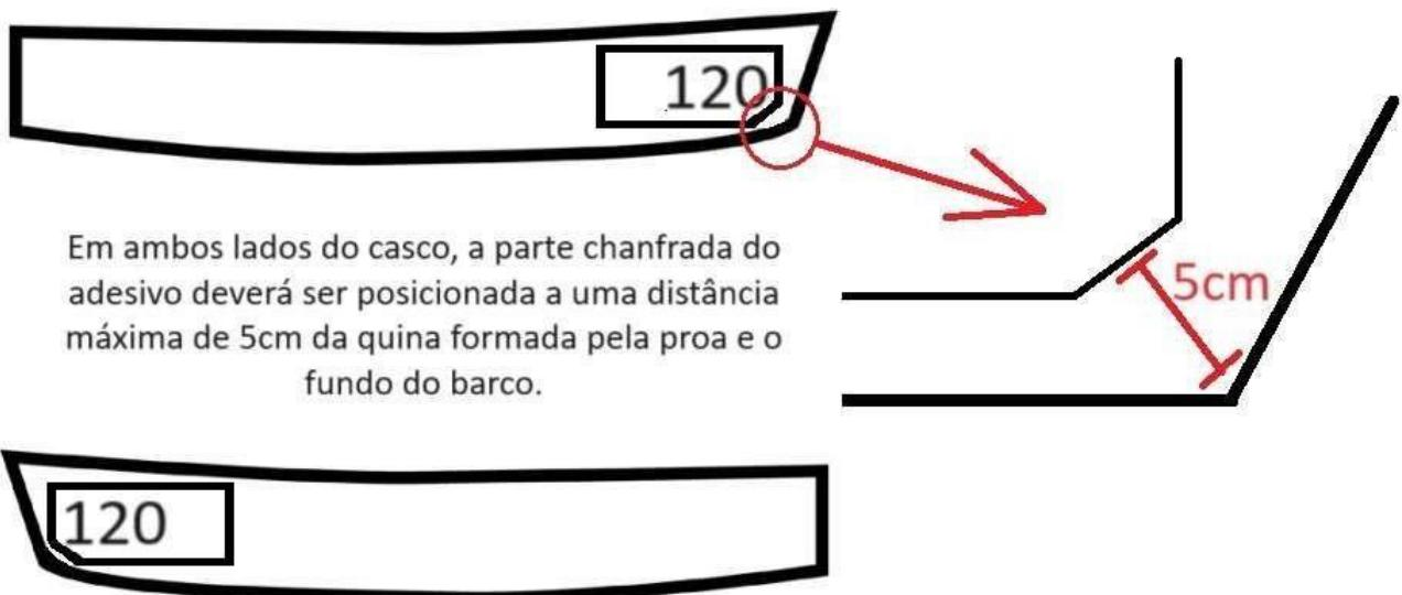
Em ambos lados do casco, a parte chanfrada do adesivo deverá ser posicionada a uma distância máxima de 5cm da quina formada pela proa e o fundo do barco.
